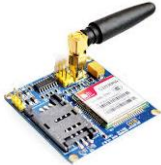
Fig. 7 SIM900A GSM modem
